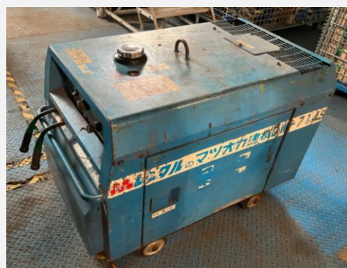
アーク溶接機 200A インバーン(ディーズル)
